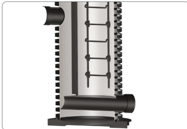
ПЕРЕПАДНОЙ КОЛОДЕЦ КП1000Г С ГАСИТЕЛЕМ ПОТОКА
