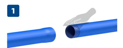
При монтаже необходимо концы труб с уплотнительными кольцами и раструбы хорошо очистить от загрязнений (песка, грязи, пыли).
