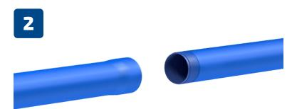
Соединяемые трубы должны быть расположены на одной оси. Трубный конец и раструб соединяемых труб должны быть расположены напротив друг друга. При монтаже конец трубы направляют в раструб и производят свинчивание до упора.
