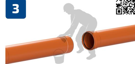
Гладкие концы труб и уплотнительные кольца в растворах необходимо смазать мыльным раствором или специальной смазкой-лубрикантом для монтажа полимерных труб. В случае монтажа при температуре воздуха ниже 0 °C рекомендуется применять мыльный раствор с добавлением глицерина (глицерин технический – 450 г, вода – 515 г, мыльный порошок (стружка) – 35 г). Использование для смазки нефтехимических масел запрещено. Недопустимо попадание на смазанные поверхности песка или других загрязнений.
