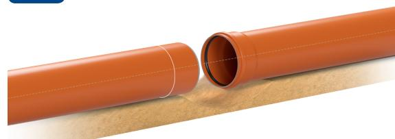
Соединяемые трубы должны быть расположены на одной оси (в месте соединения организуется приямок). Гладкий конец и раствор соединяемых труб должны быть расположены напротив друг друга. При монтаже гладкий конец трубы направляют в раствор.
