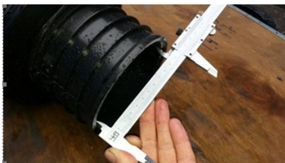
Рисунок 14 – Измерение среднего внутреннего диаметра трубы с помощью штангенциркуля
