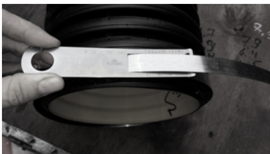
Рисунок 13 – Измерение внешнего диаметра трубы с помощью циркулем
