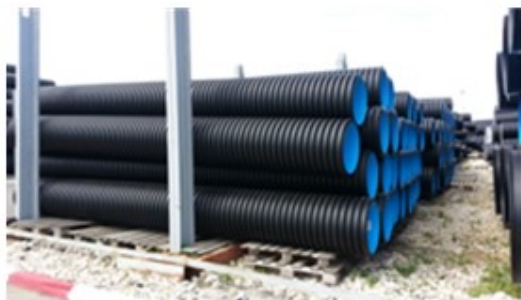
Рисунок 8 – Хранение труб в штабелях с использованием боковых опор
