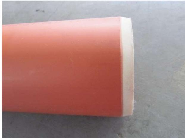
Рисунок 17 – Фаска под углом  $15^\circ$  на гладком торце трубы из НПВХ
