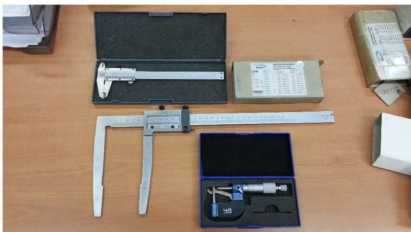
Рисунок 12 — Приборы, необходимые для проведения входного контроля
