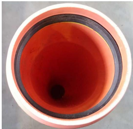
Рисунок 7 — Визуальный осмотр внутренней поверхности трубы из НПВХ
