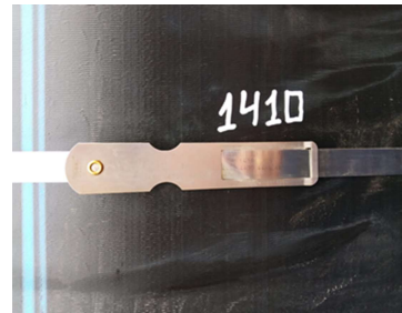
Рисунок 3 – Применение циркометра на трубе
