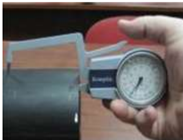
Рисунок 2 – Применение толщиномера для измерения толщины стенки
