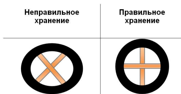
Рисунок 7 – Схема расположения распорок
