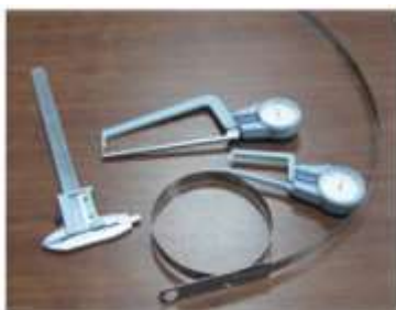
Рисунок 1 – Средства измерения геометрических размеров труб: толщиномер, штангенциркуль, циркометр*
