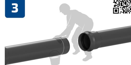
Гладкие концы труб и резиновые кольца в раструбах необходимо смазать мыльным раствором или специальной смазкой-лубрикантом для монтажа полимерных труб. В случае монтажа при температуре воздуха ниже 0 °С, рекомендуется применять мыльный раствор с добавлением глицерина (глицерин технический – 450 г, вода – 515 г, мыльный порошок (стружка) – 35 г). Использование для смазки нефтехимических масел запрещено. Недопустимо попадание на смазанные поверхности песка или других загрязнений.
