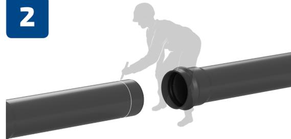
На гладком конце трубы необходимо сделать монтажную метку с тем расчетом, чтобы труба не доходила до упора в раструбе на 10 мм.
