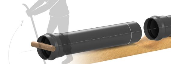
Гладкий конец ПВХ трубы необходимо вставить в раструб на глубину монтажной метки. Соединение труб осуществляется с помощью специального устройства для сборки ПВХ труб с зажимными хомутами, либо вручную, при этом в качестве рычага можно пользоваться ломом (между поверхностью лома и торцом трубы необходима деревянная прокладка).
